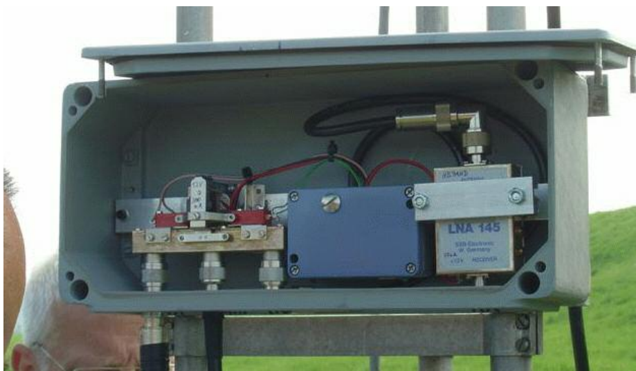
Antennenumschaltung und Vorverstärker direkt am Mast
