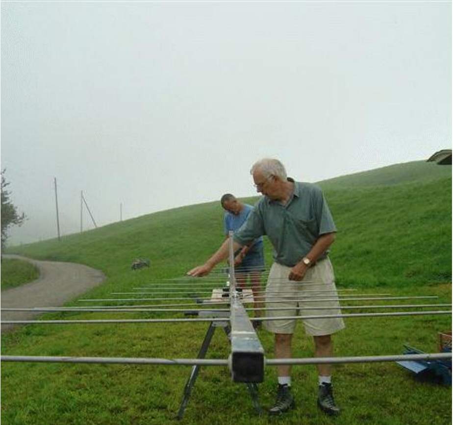
eine der zwei unendlich langen 2m Yagis (18 Elemente)
