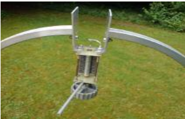
Mit dem Drehko wird auf die verschiedenen Bänder abgestimmt
