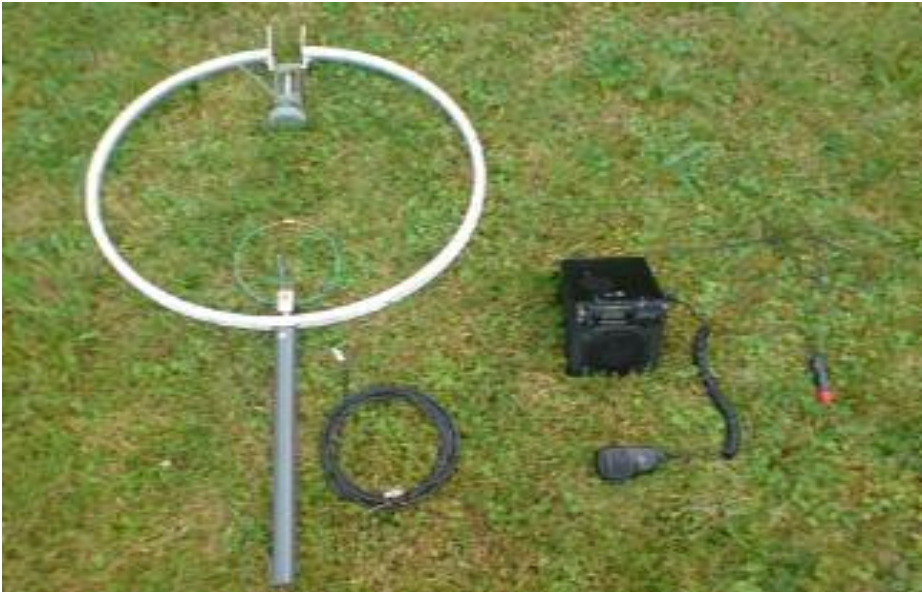
zeigen die von Edi gebaute Antenne mit FT-817 und Details der Abstimmvorrichtung.
